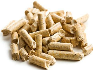
Pellets sind stäbchenförmige Holzpresslinge und werden überwiegend aus Stammholz bzw. Säge- und Hobelabfällen gewonnen. Qualitativ hochwertige Pellets erkennt man an einem seidenmatten Glanz, einer hohen Festigkeit und einem geringen Staubanteil. Gute Pellets lassen keine Längsrisse erkennen.
